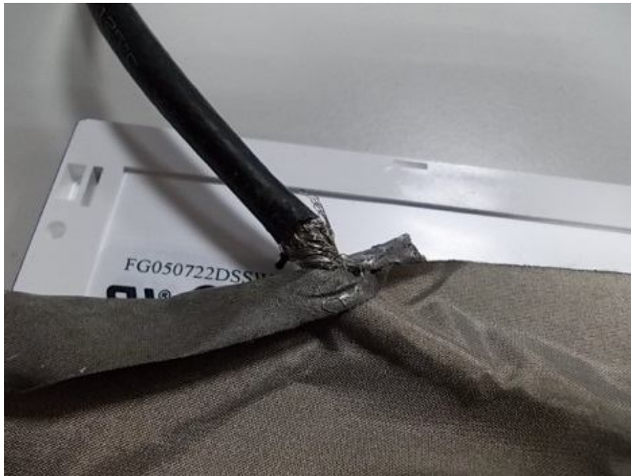
LCD CABLE 與 PANEL SHIELDING 搭接示意圖 2
