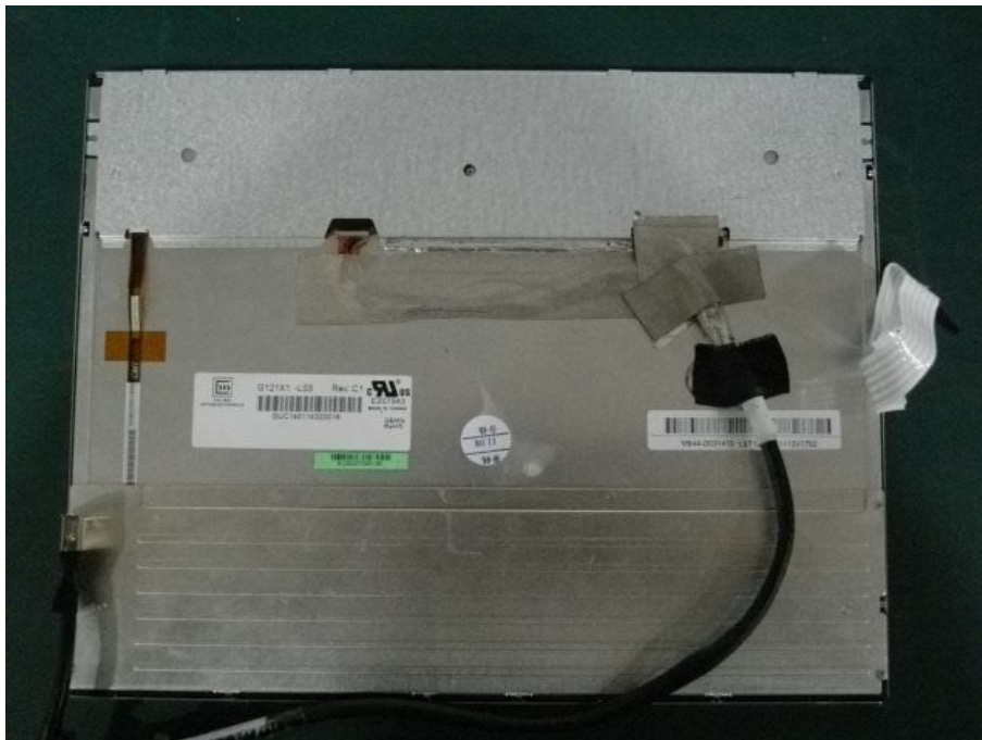
LCD CABLE 與 PANEL SHIELDING 搭接示意圖 1-2
